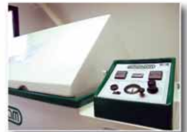
CÂMARA DE CORROSÃO
