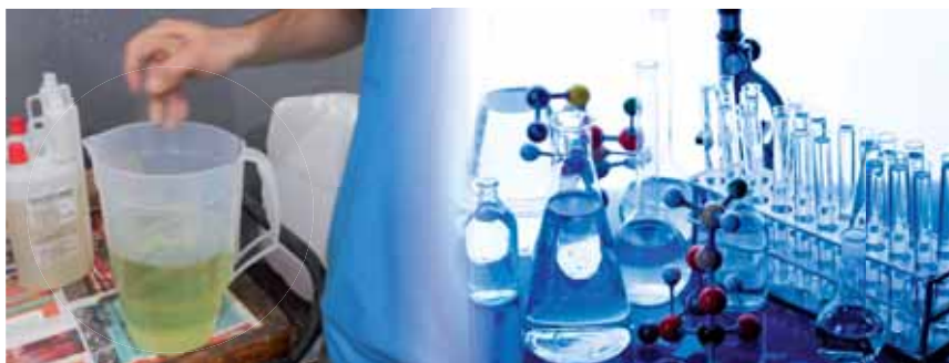
Acima, exemplo de preparação da resina líquida FST 822 a ser aplicada manualmente entre duas lâminas de vidro previamente tratadas (ver detalhes do processo de laminação no quadro desta página)
