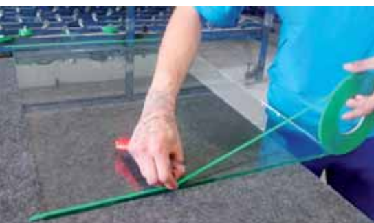
ETAPA 1: limpeza das lâminas de vidro (acima) e colagem das duas lâminas com fita dupla face (abaixo)
