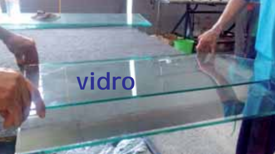
ETAPA 1: limpeza das lâminas de vidro (acima) e colagem das duas lâminas com fita dupla face (abaixo)
