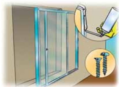
Instalação sem contramarco, por meio de fixação química
