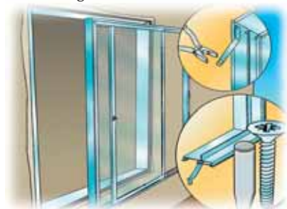
Instalação sem contramarco, por meio de fixação mecânica
