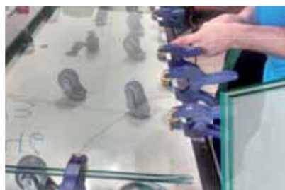
ETAPA 3: após a finalização do preenchimento com resina, o vidro segue para a mesa de descanso (abaixo)
