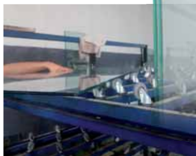
ETAPA 3: após a finalização do preenchimento com resina, o vidro segue para a mesa de descanso (abaixo)
